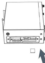
C. 将侧盖装回路由器并拧紧螺丝。
