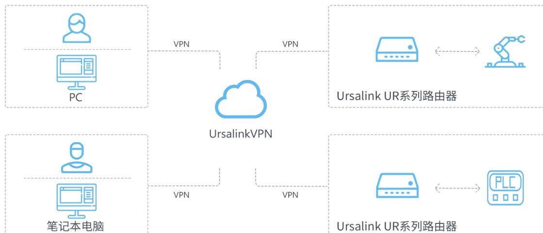
在服务器上安装 UrsalinkVPN 软件作为 VPN 服务端，将 PLC 等工业设备与 Ursalink 工业路由器连接。路由器和控制站点（笔记本电脑或其他设备）作为 VPN 客户端，通过 UrsalinkVPN 与 VPN 服务器连接，使控制站点能够远程访问和配置设备。在 UrsalinkVPN 服务端界面上可以查看 VPN 实时数据传输信息。
