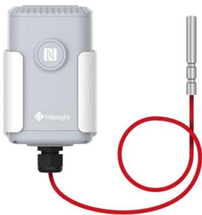
EM500-PT100 传感器是一款设计简约美观、功能强大的温度传感器。EM500-PT100 传感器采用高精度铂热电阻元件，支持测量从-200°C 到 800°C 的高温范围，并通过无线 LoRaWAN 通信技术传输到远程平台。
