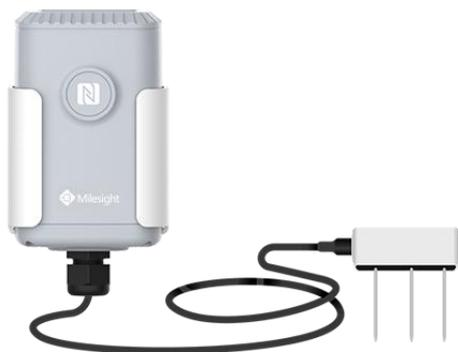
EM500-SMT 传感器是一款设计简约美观、功能强大的土壤传感器。EM500-SMT 能够采用防水耐腐探针，能够准确采集水分、温度、电导率等多种类型的土壤数据，并通过无线 LoRaWAN 通信技术传输到远程平台。
