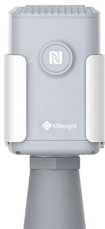
EM500-UDL 传感器是一款设计简约美观、功能强大的超声波测距传感器。EM500-UDL 传感器采用超声波回波测距原理，使用精确的时差测量技术检测传感器与目标间的距离，并通过无线 LoRaWAN 通信技术传输到远程平台。
