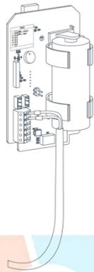
4. 完成安装后将主板装回并锁上外壳螺丝。
