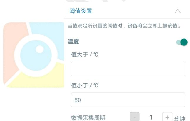
方法二：电脑上打开 Toolbox 软件并进入配置界面，在“设备设置 > 基本信息 > 阈值设置”页面配置对应传感器的阈值。
