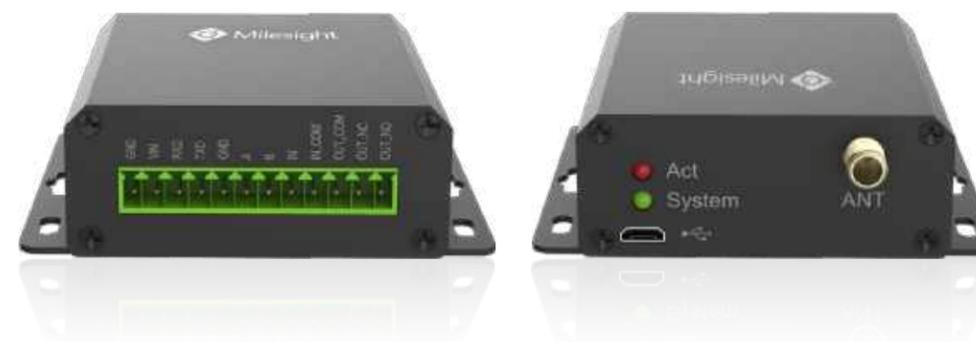
工业数传终端(DTU)采用高性能工业级芯片，低功耗及宽温宽压设计，适用于严苛的使用环境；丰富的数据传输接口，支持上百种触发条件及响应动作，可以轻松监控/控制远端设备，用户无需奔波于工作现场与控制中心。
