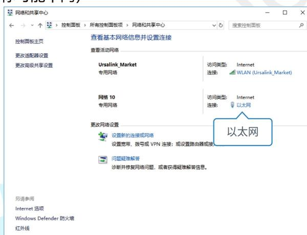
3. 进入“属性” -> “Internet 协议版本 4 (TCP/IPv4)” 页面后，选择“使用下面的 IP 地址”，手动配置一个与网关子网相同的 IP 地址。
