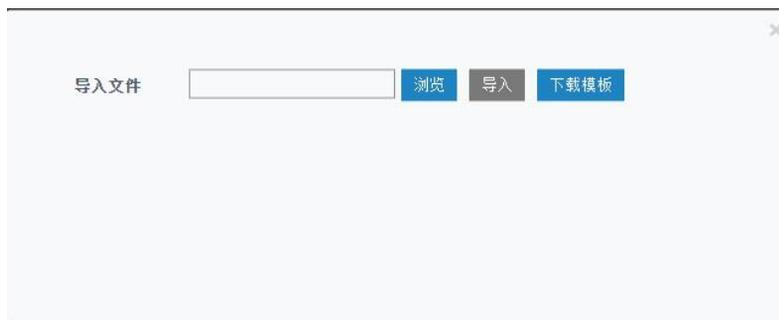
点击“下载模板”后按模板的格式添加节点设备，application, deviceprofile 与前面配置的参数一致，余下参数根据终端是 OTAA 还是 ABP 进行添加。
